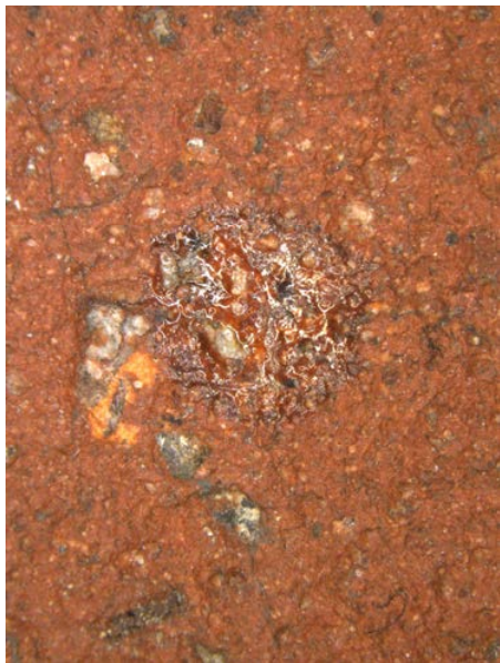
Obr. 1. Vnitřní povrch muflové klenby pokrytý parami klejtu s kapkou klejtu uprostřed (šířka snímku 7,5 mm).
