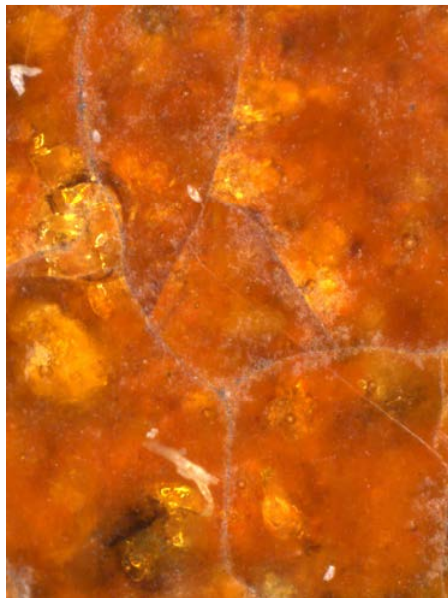
Obr. 2. Vnitřní povrch muflové klenby pokrytý silnou vrstvou par klejtu (šířka snímku 0,75 mm).
