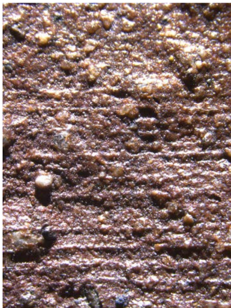
Obr. 3. Vnitřní povrch muflové klenby, prstování (šířka snímku 7,5 mm).
