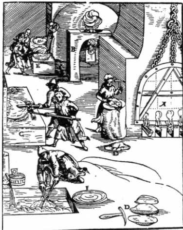
1574 - vycezovací, rafinační a třídící pece, měděné bochníky (Ercker 1974, 199).
