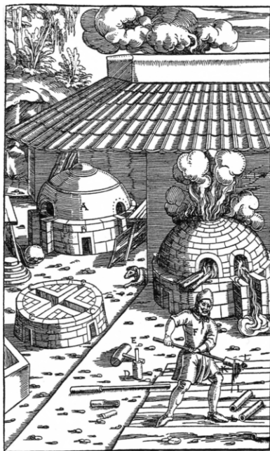
1556 - polská a uherská sháněcí pec. Dělník vyrábí z klejtu trubky (Agricola 2001, 448).
