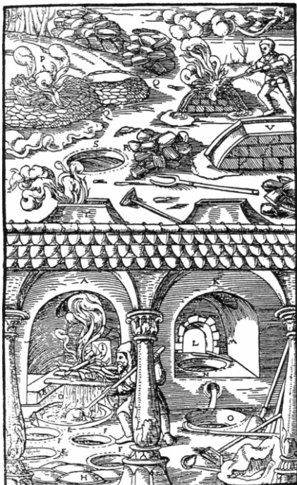
1556 - vycizování olova z váp. rud: pece: A - korutanská, K - saská, V - polská, P - vestfálský způsob tavení (Agricola 2001, 384).
