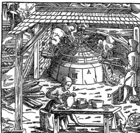
1556 - sháněcí pec na oddělování olova od stříbra nebo od zlata (Agricola 2001, 442).
