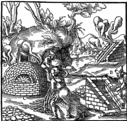
1556 - způsoby pražení olověných rud, dole vrstva pražení, na ní dřevo (Agricola 2001, 281).
