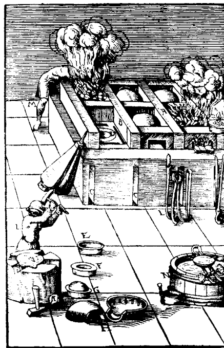
Obr. 4. Přepalování stříbra pod muflí.
