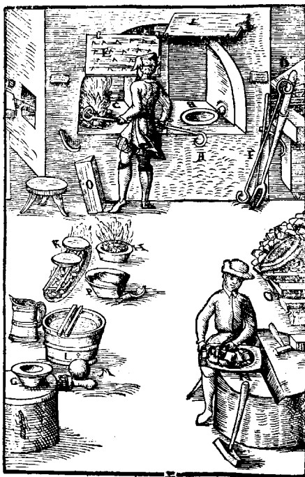
Obr. 3. Přepalování stříbra dle způsobu staršího.
