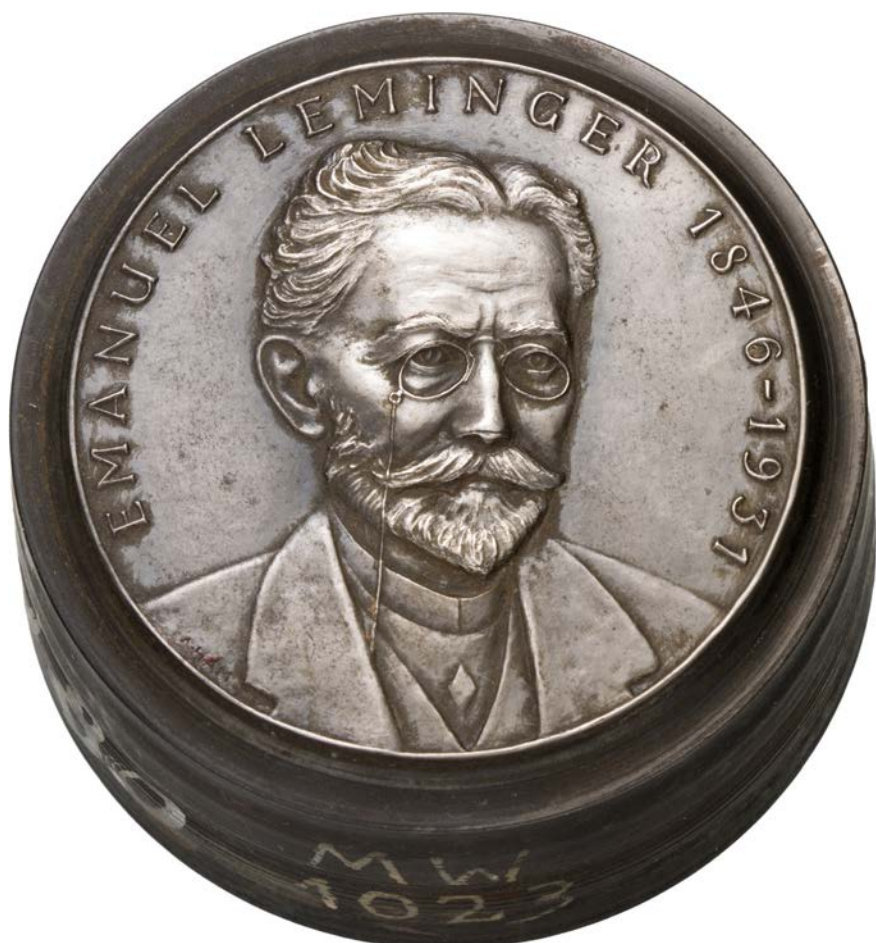
Patrice aversu – model medaile zmenšený na finální velikost medaile, ocel, Sbíрка ČMS, inv. č. M5/4
